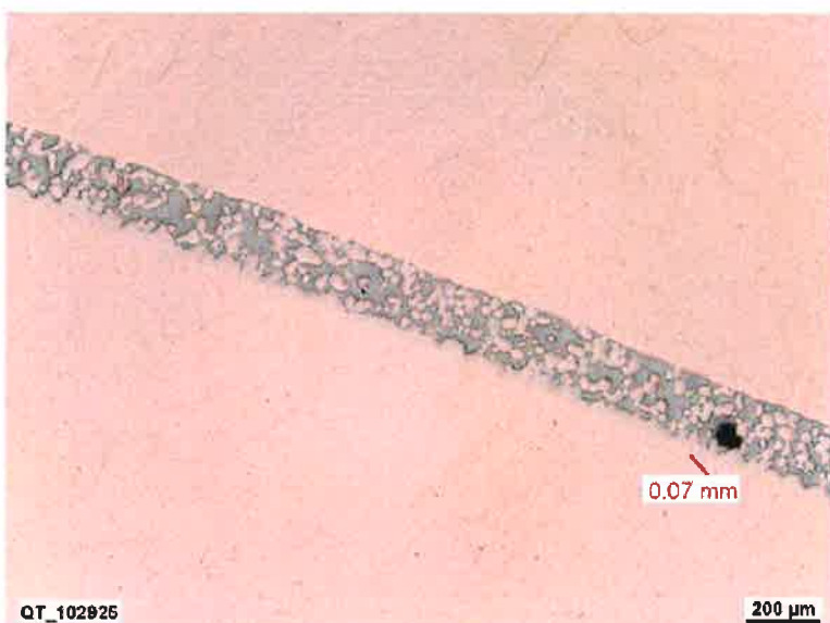
Bild 3: Lichtmikroskopische Dokumentation; BPQR-002; Querschliff, ungeätzt
